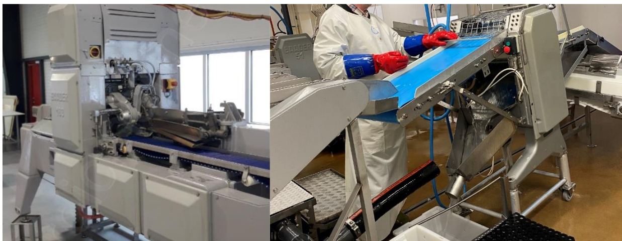
Figur 7. Fileterings- og skinnemaskinen brukt i utbytteforsøkene.
